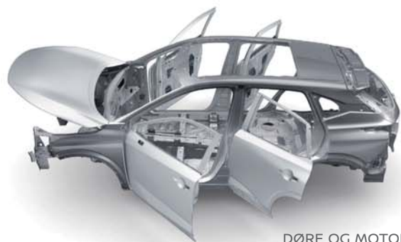
DØRE OG MOTORHJELM I ALUMINIUM Lettre aluminiumsplader i døre og motorhjelme reducerer vægten og dermed også CO 2 -emissionerne.
